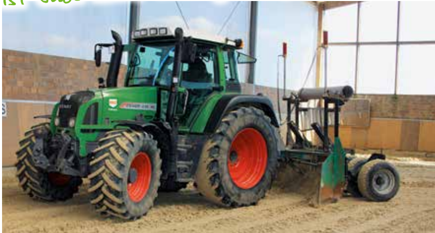
In der Reithalle wird die Fläche mit Laser ausnivelliert.
