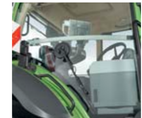
Der 220°-Seitenscheibenwischer gewährleistet auch bei widrigen Bedingungen eine optimale Sicht zur rechten Seite.
