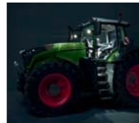
Bei der Coming-Home-Funktion leuchten die Scheinwerfer und die Stufenbeleuchtung nach Abstellen des Motors nach, sodass der Heimweg sowie die Trittstufen beleuchtet sind.
