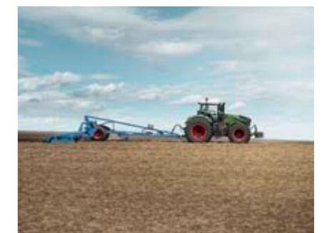
Dank Traktor-Management-System TMS und automatischer Grenzlastregelung 2.0 stimmt der Traktor die Motordrehzahl optimal auf die Fahrgeschwindigkeit ab.
