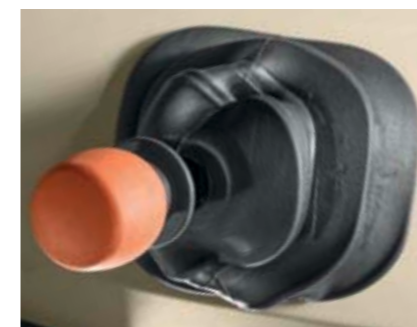
Handbremsassistent in Automatikstellung: Die Handbremse ist automatisch aktiviert.
