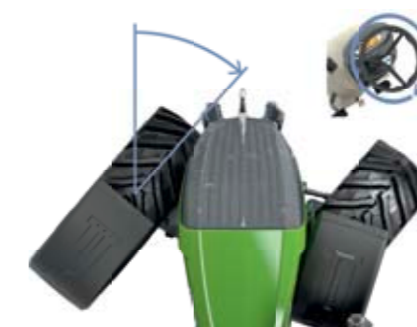
Mit VarioActive erreichen Sie schon mit einer Lenkradumdrehung den vollen Lenkeinschlag.
