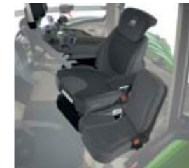
Der Super-Komfortsitz Evolution dynamic ist luftgefedert und verfügt über eine aktive Klimatisierung sowie eine Rückenlehnenverlängerung.
