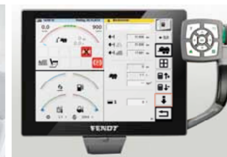
Die neue Ertragsmessung erfasst neben der bearbeiteten Fläche in ha, die geerntete Frischmasse und die Durchsatzleistung.
