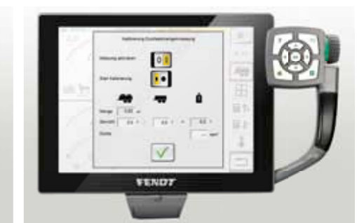
Die Kalibrierung erfolgt durch einfaches Gegenwiegen.
